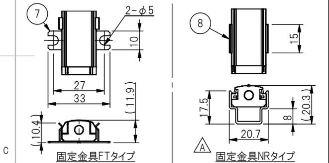
※ライン照明固定金具は、吊り下げ固定時、壁面固定時のオプションです。数量は、ライン照明のL(全長)により変わります。数量についてはご相談ください。
