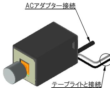
参考図(1/2) 調光器ユニット(エル光源製) コントロールパネル等に取付けて使用
